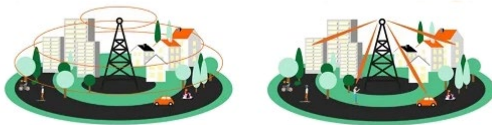
Stralingsprincipes van een passieve antenne (links) en een actieve antenne (rechts).
